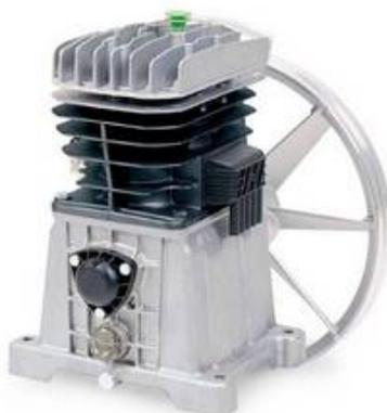
**Поршневой блок Fiac AB360** предназначен для нагнетания сжатого воздуха в ресивер компрессора. Сжатие в поршневом блоке происходит за счёт вращения шкива, через ременную передачу. Поршневой блок Fiac AB360 является маслозаполненным, смазка трущихся поверхностей деталей блока поршневого осуществляется разбрызгиванием масла.
