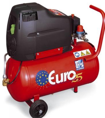
Поршневой безмасляный компрессор Fiac Euro 50 служит для подачи сжатого воздуха в пневмоинструмент. Прямой привод обеспечивает высокий КПД. Данный агрегат вырабатывает 170 литров сжатого воздуха в минуту и оснащен ресивером на 50 литров. Колеса и рукоятка упрощают перемещение компрессора по рабочей площадке.
