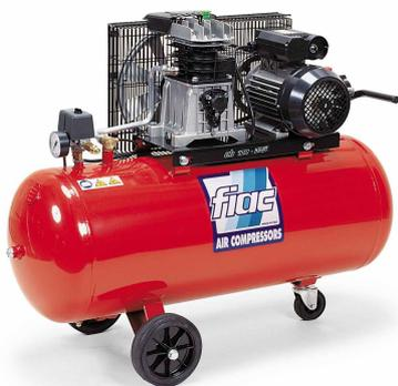
**Поршневой компрессорный агрегат Fiac AB 300-858 TC** с ресивером на 270 литров развивает продуктивность 830-850 л/мин. Масляный компрессор оснащен электродвигателем на 5,5 кВт, который обеспечивает давление 9,87 атмосфер. Оборудование предназначено для обслуживания строительного и ремонтного пневмоинструмента.
