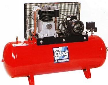
**Модель FIAC AB 300-678** оснащена электрическим двигателем и имеет маслonaполненную 2-х ступенчатую 2-х цилиндровую поршневую группу с воздушным охлаждением. В состав оборудования включен ресивер на 270 литров, корпус ресивера выполнен из износостойкого сплава, защищен от коррозии и механических воздействий.
